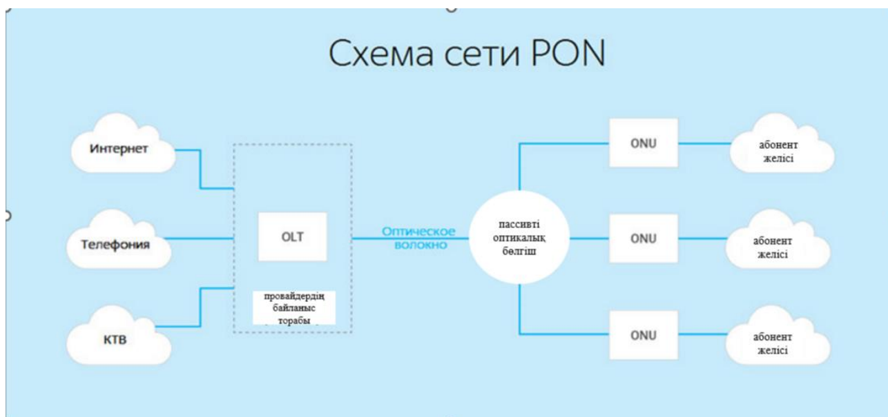
1.3- сурет – Пассивті оптикалық желіні құру технологиясы (PON)
